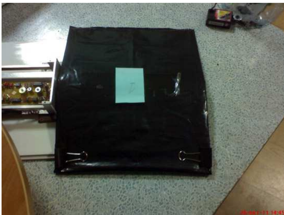
Фото 20. Геометрия эксперимента при проверке наличия рентгеновского излучения при работе СНМ-14 в режиме регистрации зарядовых кластеров.
